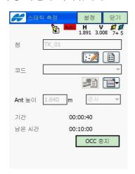
12. 일반적으로 Static 측량은 1시간 이상 측정을 하게 됩니다. 남은 시간은 Fast Static 측정 기준으로 나타나는 시간이오 니 이점 유의하시기 바랍니다.
